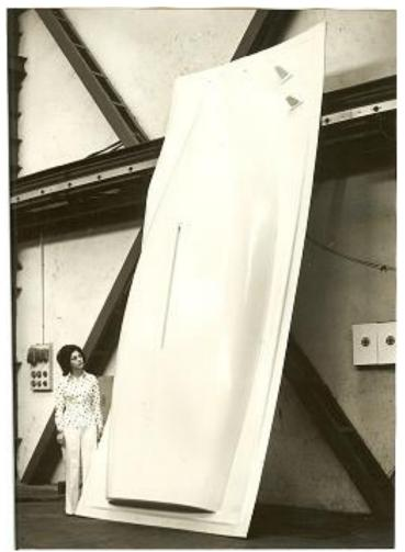
La macchina aveva area di formatura di 7 metri x 3 metri, con una profondità di 1000 mm. Vi mando, via WeTransfer, foto e video. Oggi sembra una cosa da mausoleo, però consideriamo che sono passati 48 anni. Allora ero dipendente della Triulzi SpA.
