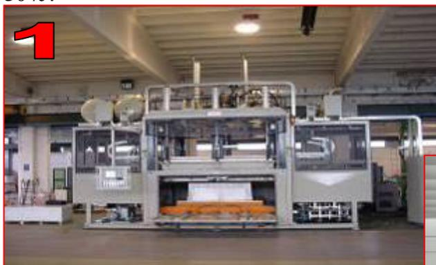
*Es. di macchina termoformatrice SS-FV, in versione idraulica, Cliente Plastoform – Slovenia, mod. dal 1997 al 2004.*
