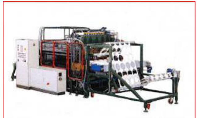
*Esempio di macchina termoformatrice Speedy PT, da bobina – Con solo vuoto. Macchina elettromeccanica, adatta alla produzione di piatti a perdere e simili.
