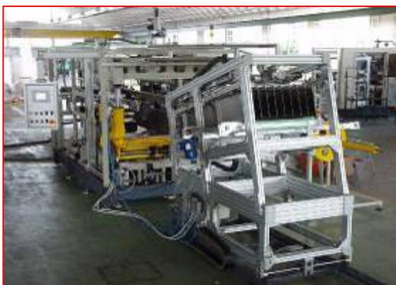
*Es. di macchina termoformatrice mod. Speedy Tilting, da bobina, adatta alla produzione di bicchieri e cestini per alimenti etc.
