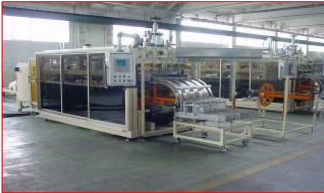
*Es. di macchina termoformatrice Speedy BC, da bobina. E' del tipo elettromeccanica. È adatta alla produzione di bicchieri a perdere, cestini per alimenti etc.
